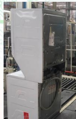
Centro de lavado visto en la cara posterior, el exhaust se aloja en la parte media.
