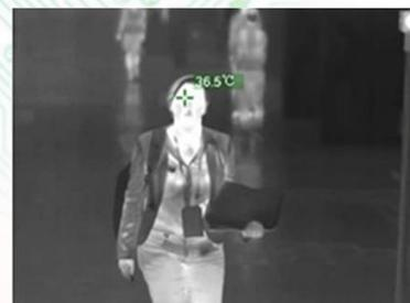
Ejemplo de medida de temperatura facial mediante una cámara termográfica.
